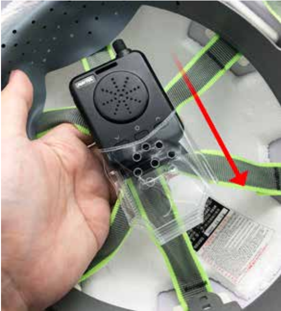
Die Lautstärke der Sprechfunkdurchsagen wird durch den Helm verstärkt.
